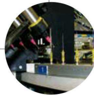
Auftragen des Klebstoffs
