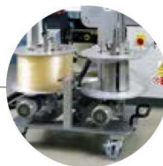
Automatische Schlauchzuführung und automatisches Erkennen der leeren Spule
