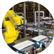
Robotergesteuertes Befüllen von Infusionsbeuteln mit Lösungen
