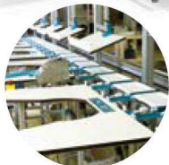
Automatische Förderanlage, manuelle Montage von Infusionsbeuteln
